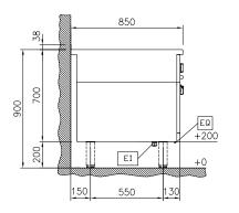
Electrical inlet (power) Equipotential screw Electric
